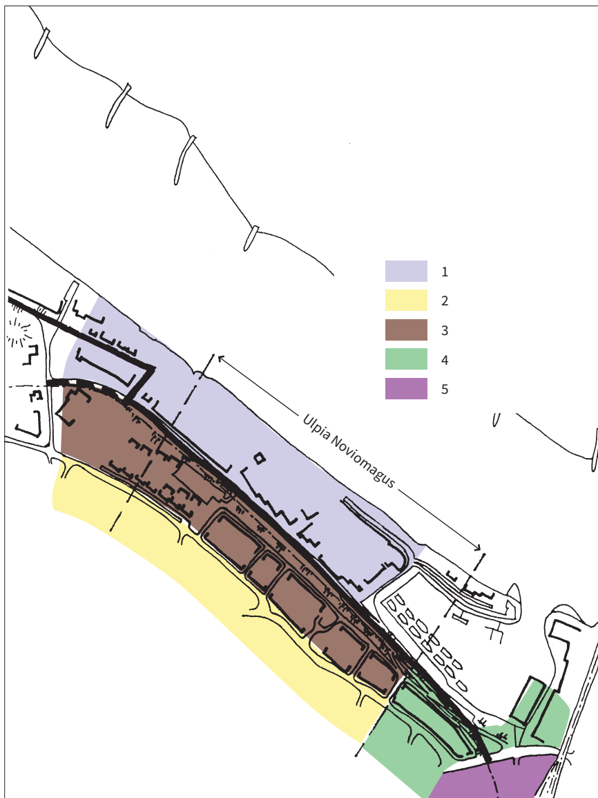
Figuur 33. (Diepte-)ligging van de Romeinse resten in het Waalfront. Legenda: 1: Romeinse resten tussen 2–4 m –mv, en dieper; 2: Romeinse resten tussen ca. 0,6–2,5 m –mv; 3: Romeinse resten diepteligging onbekend; 4: grafveld Hees; 5: 17 e -eeuwse vestingwerken. Naar Zijlstra & Verhaak 1997, 96, fig. 6.10.
