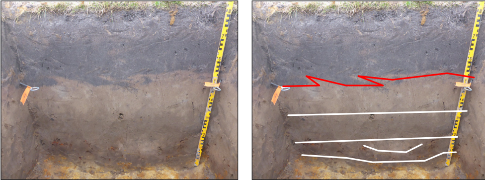
Afb. 3.23 Lage Mierde 3. Westprofiel profielput 11, ter hoogte van boring 44, maaiveldhoogte 24,68 m NAP. In rood de interpretatie van het verloop van de grens van de bouwvoor, in wit de overige in de tekst genoemde lagen.
