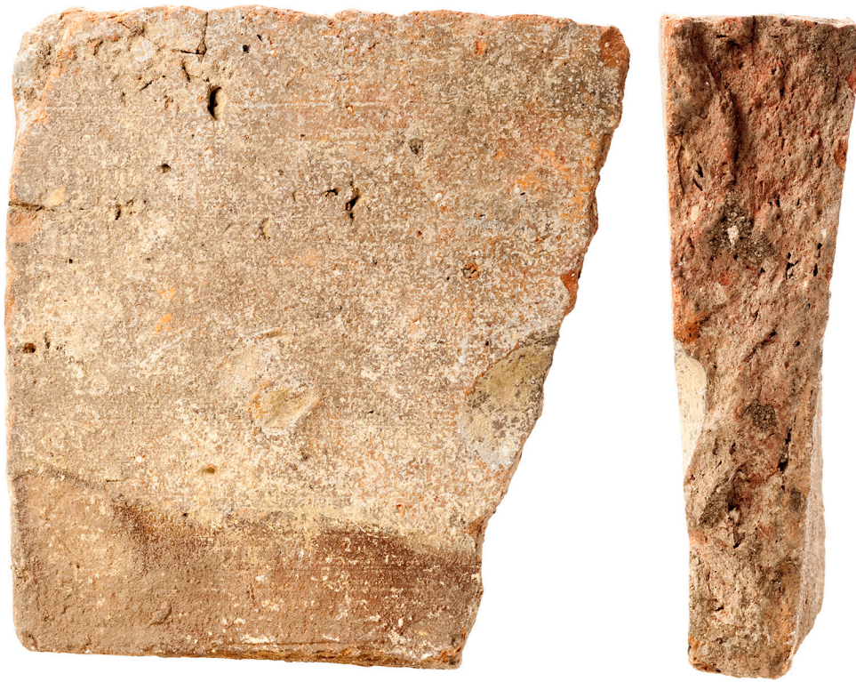
Figuur 7. Voor- en zijaanzicht van de wigvormige baksteen. Schaal 1:2.
