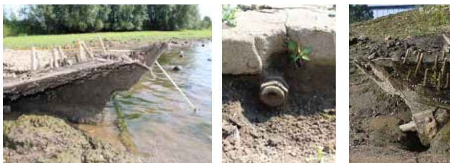
16-18. Links en rechts de scheg met beneden de aandrijfstang. De keep is aangebracht om de schroef te kunnen laten roteren. Midden: het andere uiteinde van de aandrijfstang van de schroef onder een ballaststuk.
