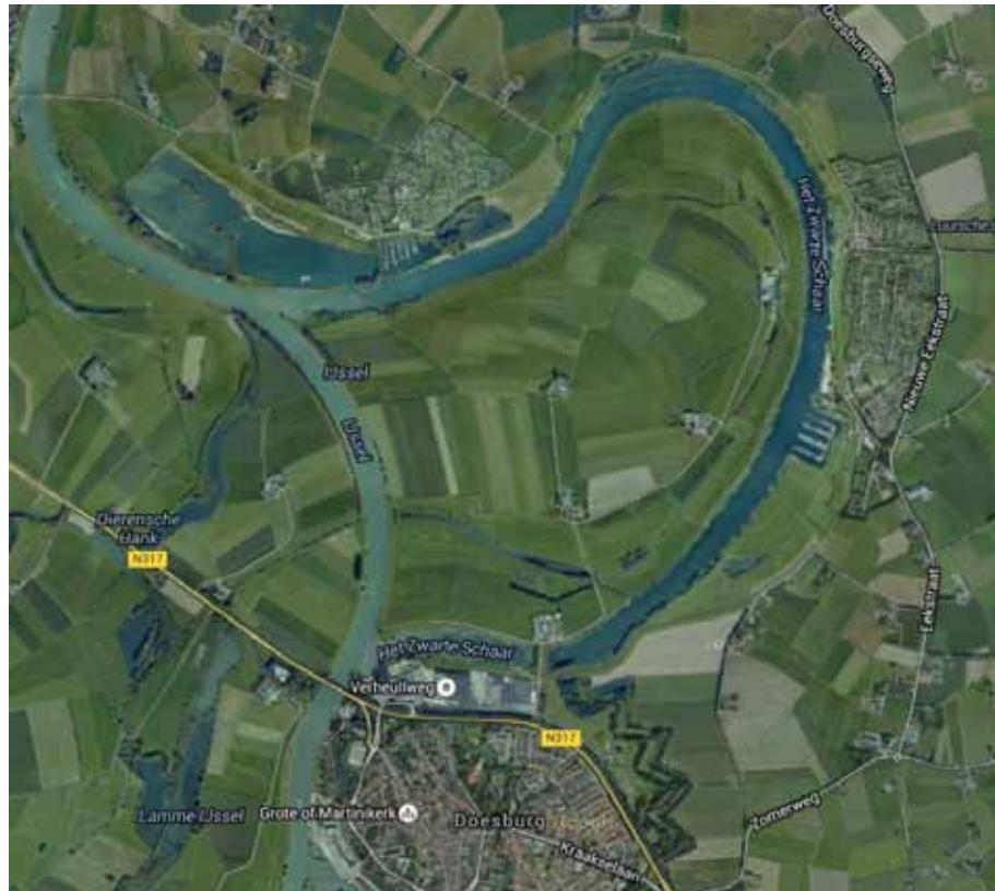
7. Satellietfoto van het Zwarte Schaar rond de Fraterwaard, waarop duidelijk is te zien dat het om een afgedamde IJsselmeander gaat. Links zijn ook nog enkele oudere meanders te zien: de Lamme IJssel en de Dierense Hank.
