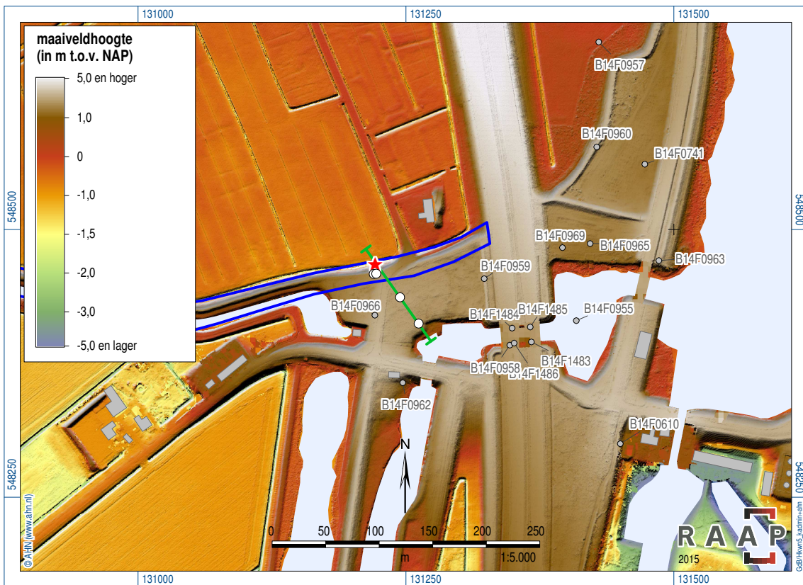
Figuur 4. Boven: Locatie van het gemaaltje (ster) en de persleiding (blauwe stippellijn) op de kadastrale minuut; onder: ligging van het gemaaltje (ster), de verkennende boringen (witte bolletjes), het AMK-terrein (blauwe lijn), geologische boringen (grijze bolletjes) en de doorsnede uit figuur 6 (groene lijn) op het Actueel Hoogtebestand Nederland (AHN2, 50 cm-grid).
