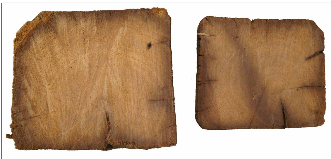
Afb. 107 Twee houtmonsters van de molenroede. De schuine bovenhoek op het linkermonster wordt veroorzaakt door de aanwezigheid van de wankant (buitenzijde boom) en is geen bewust afgeschuinde hoek.
