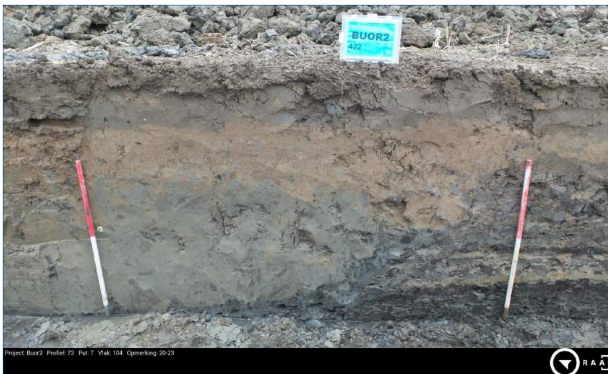
Figuur 20. Westprofiel in put 7. Links: ophogingsagen; rechts: overslagafzettingen.
