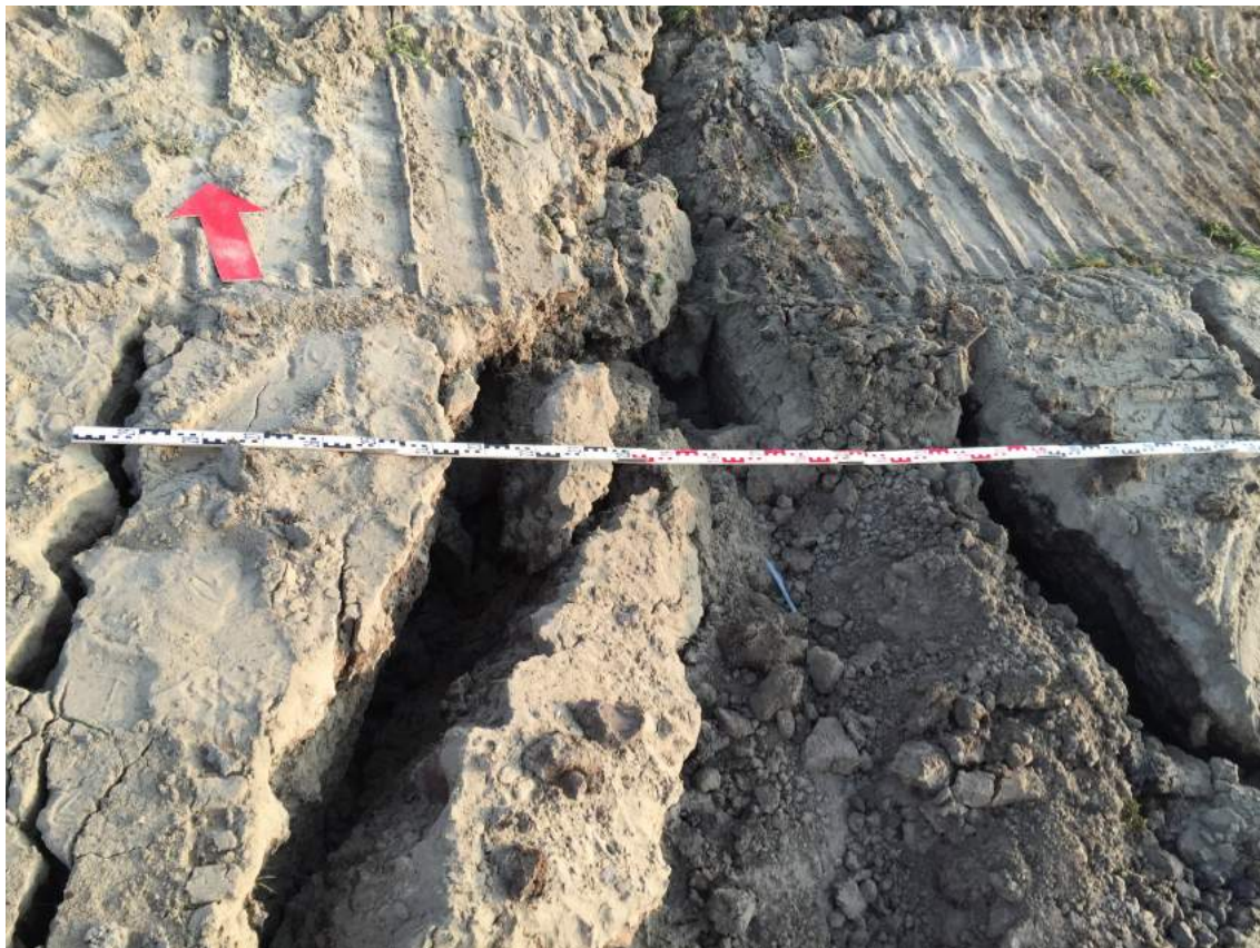
afbeelding 2: scheuren in bodem als gevolg van het infresen.
