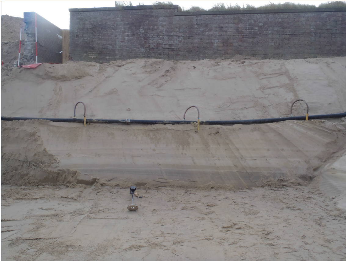
Figuur 6.1. De bodemopbouw in het plangebied. In dit profiel bevinden zich alleen de natuurlijke lagen (Jong Duinzand). Onderaan het profiel is de gelaagdheid in het duinzand duidelijk zichtbaar. De ophogingslagen zijn in dit deel van het profiel verdwenen bij de aanleg van de boulevard.
