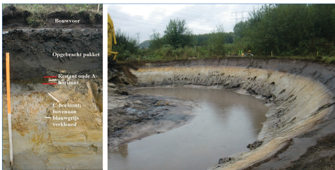
Figuur 3. Het bodemprofiel ter hoogte van de oostelijke meander met aanduiding van de lagen en een overzichtsfoto met een deel van deze uitgegraven meander.
