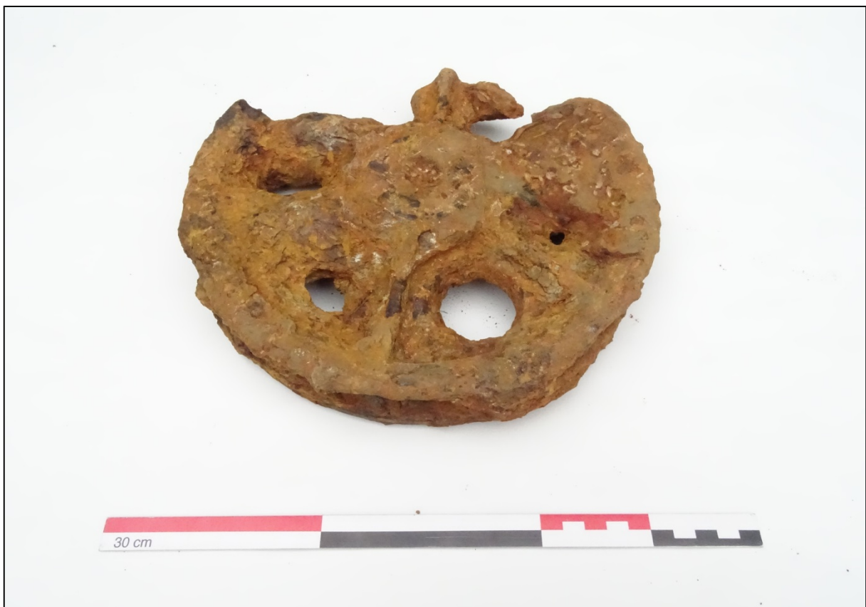
Vondstnummer 10. Stalen katrol, afkomstig van graafmachine (vermoedelijk uit periode van aanleg Afsluitdijk)
