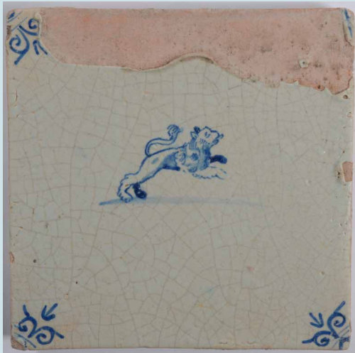
Wandtegels met dieren uit de kelder op de hoek Pakhuisstraat / Jeudje. Bij de tegels 1 en 2 is het glazuur opgekrompen en bij tegel 3 is het glazuur aan de bovenzijde slecht gehecht.
