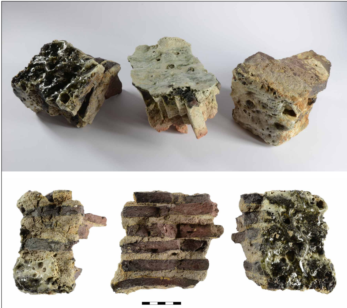
66. Boven: drie brokken van de ovenwand. Onder: zij-, voor- en achteraanzicht van een van de brokken, bestaande uit op elkaar gestapelde (dak)tegels. Op de ovenwand bevindt zich een dikke grijsgroene glasachtige substantie.
