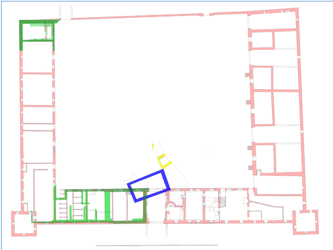
Figuur 9.4 Plattegrond van de bouwhoeve, zoals deze door A. Mulder is opgemeten. In twee tinten groen zijn de door de TH Delft vrijgegraven muren weergegeven. In blauw en geel zijn de funderingen van oudere (van vóór 1650) gebouwen aangegeven. Op deze tekening ontbreken de opmetingsgegevens van RAAP.
