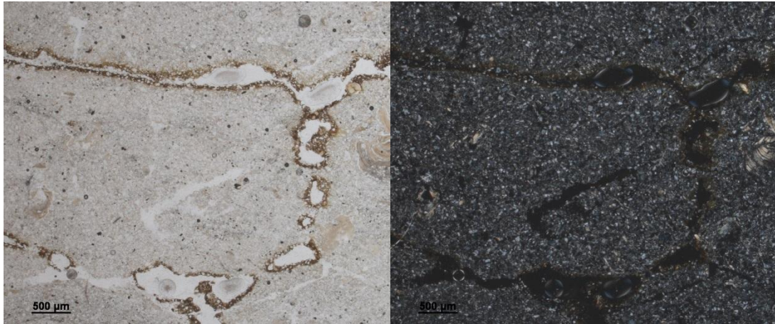
23. Hypocoatings , ingespoelde klei (PPL)
