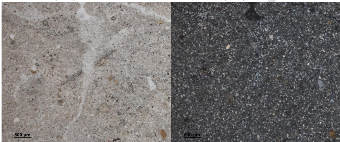
25. Verticale scheur met opvulling met kwarts (PPL)
