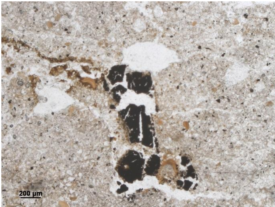
Afb. 32. Slijpplaat 3: verbrand, organisch materiaal.
