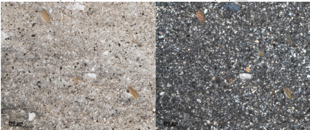
31. Dichte matrix met klei fragmenten (PPL)
