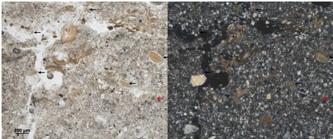
19. Klei fragmenten (zwarte pijlen), glauconiet korrel (rode pijl) (PPL)
