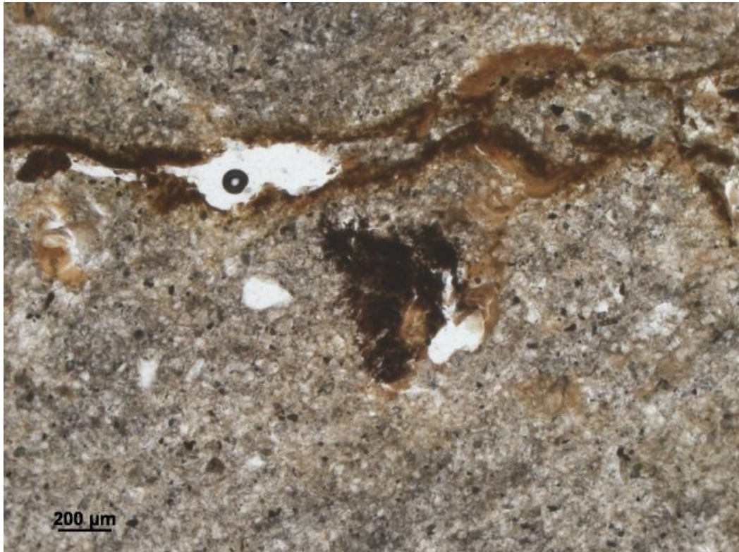
Afb. 30. Slijpplaat 2: in situ gevormde mangaankorrels.
