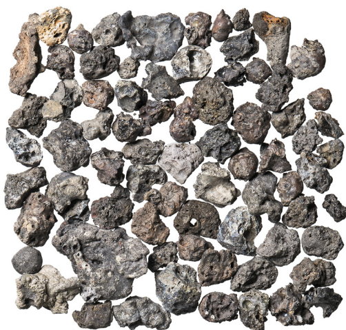
Fig. 20.1 Smeedhaardslak V368. Planoconvexe smeedhaardslak met duidelijk zichtbaar het gat van de tuyère.
