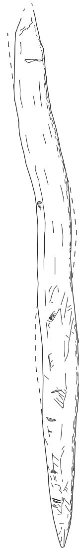
Fig. 21.72 Rechts: voorbeeld van een gerechte paal, V431. Ter hoogte van de stippellijnen is de kromming uit de paal gehaald.
