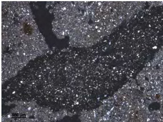
Verweerde/aangetaste kruimel (aggregate) (XPL)
