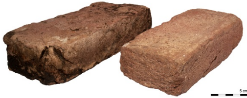
25 Baksteen uit de oudste kademuur (OZV15-8-1) en uit de meest recente (OZV15-3-1), en de dichtgezette riooldoorlaat in de kademuur gezien vanaf de grachtzijde
