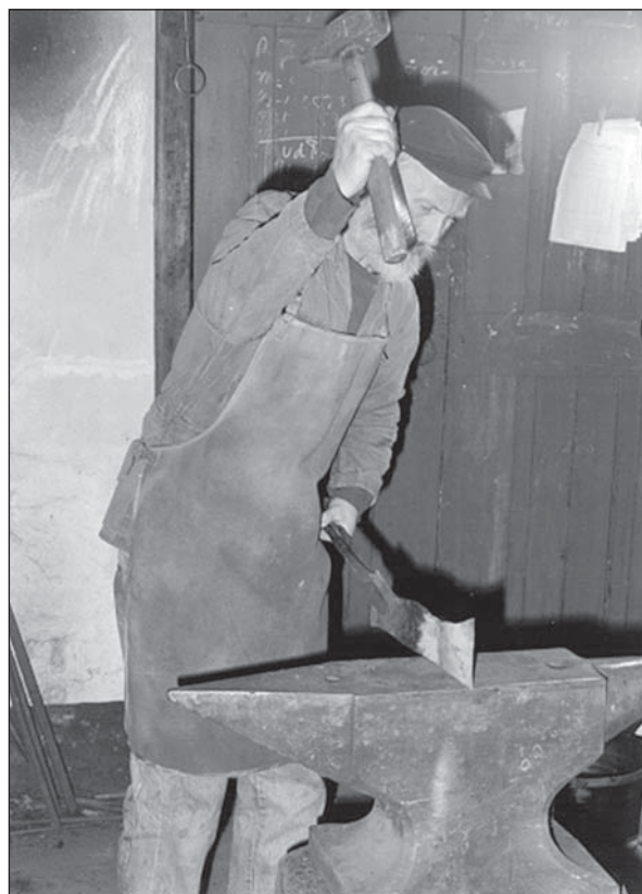
Fig. 3.38 Het smeden van de replica van de bijl. De smid is Klaas Kleine uit Diever (Foto: RCE).
