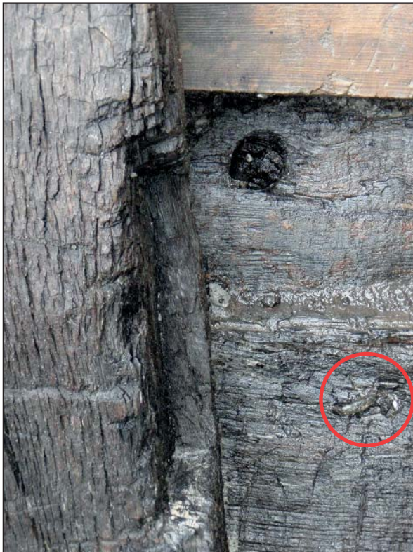
Fig. 3.20 De sponning in spant 18 waar de zeilbalk in valt. In het midden van de sponning zijn, rechts van het spant, twee sintels zichtbaar. Onder de sintels is in de gang een (tweemaal) omgeslagen spijker te zien (rood omcirkeld) (Foto: G.G.W. Schreurs, RCE).
