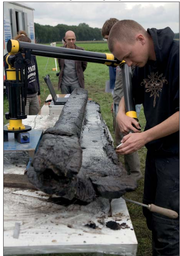
Fig. 3.5. De meetarm kan natuurlijk ook gebruikt worden om losse onderdelen van het wrak buiten de werkput op te meten (Foto: T. Penders, RCE)
