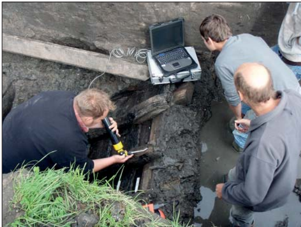
Fig. 3.4. Opmeten van een deel van de huid, met behulp van een digitale meetarm. De metingen zijn in real-time zichtbaar in een CAD-programma op de laptop (Foto: G.G.W. Schreurs, RCE).
