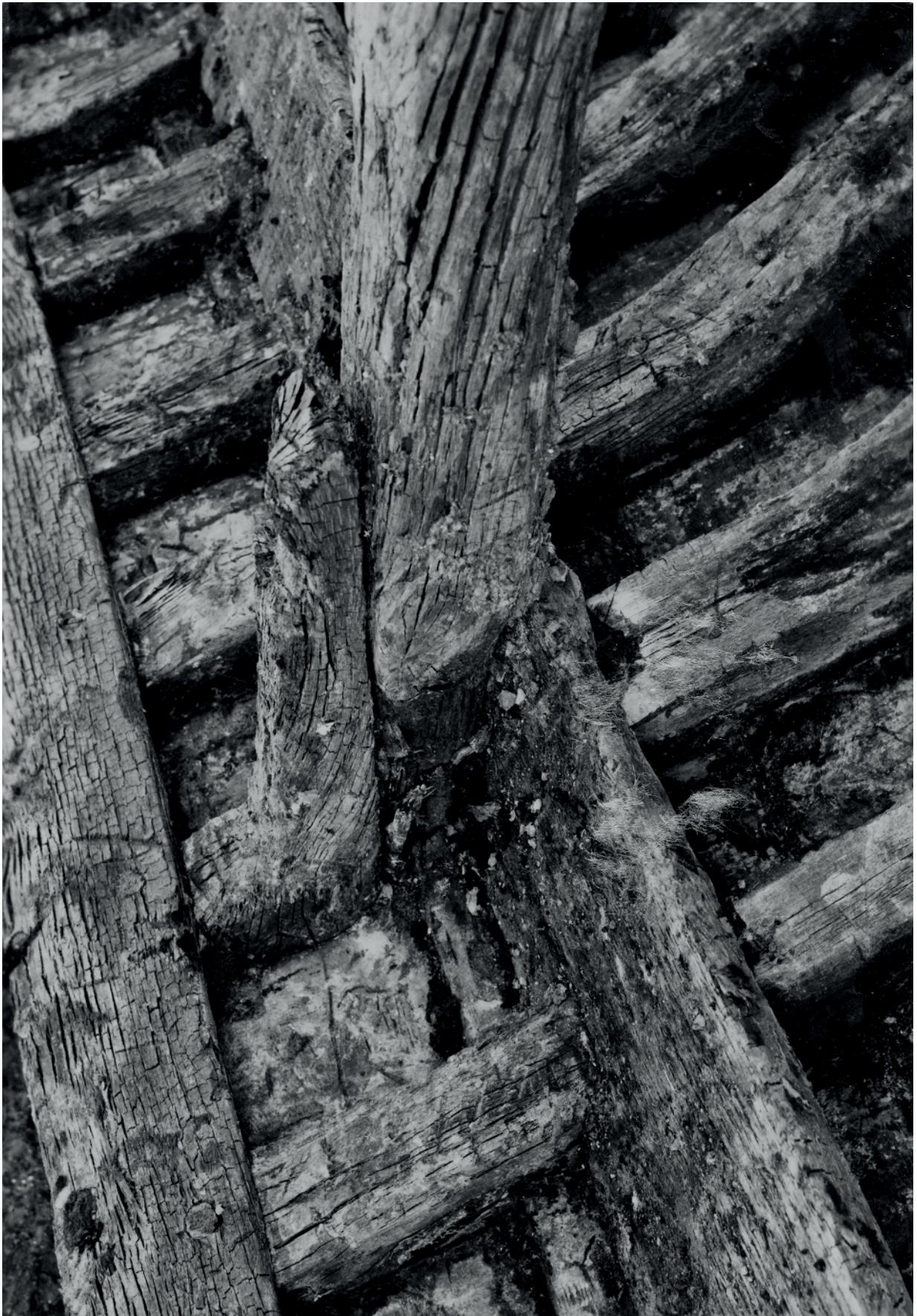
Archieffoto: 1944-119. Detailopname van de bakboordwand met gangboord en deklegger. © Rijksuniversiteit Groningen, Groninger Instituut voor Archeologie
