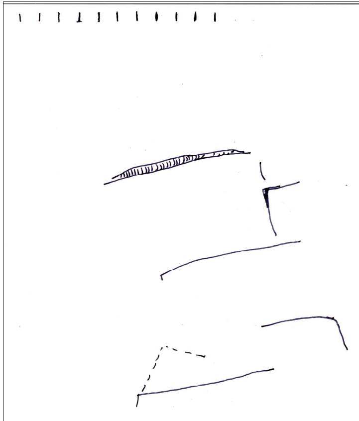
Figuur 9 Vasse-Steenbrei 3, de afdrukken van wat waarschijnlijk een dissel is geweest, op het bekapte uiteinde van de balk (M41-sub. 6) (© BIAX Consult).
