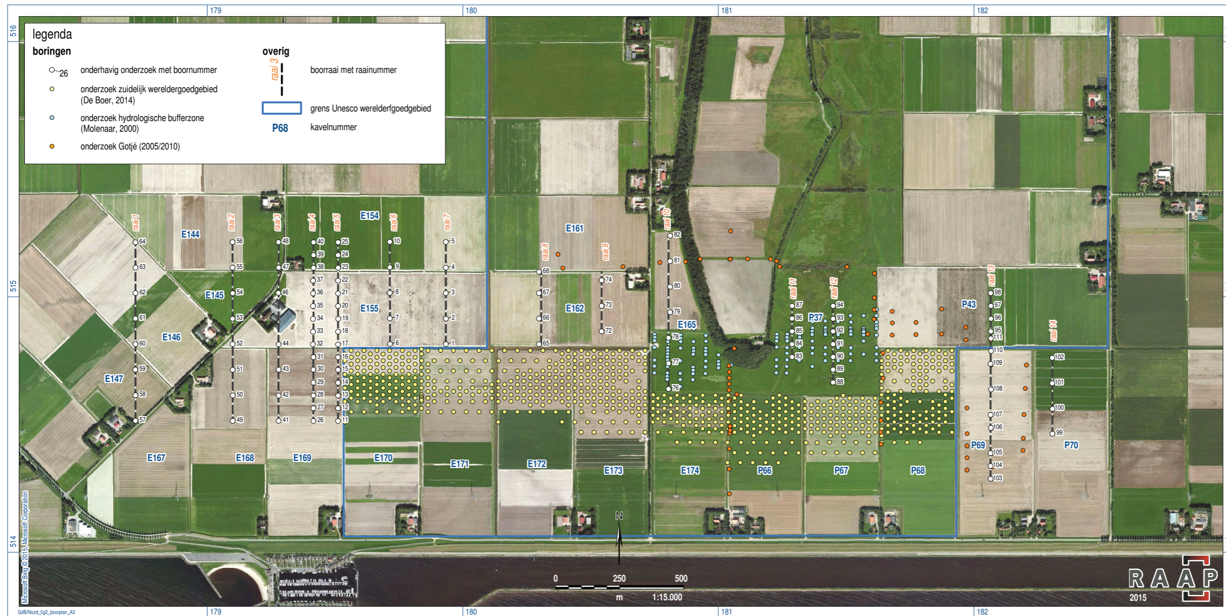
Figuur 2. Ligging van de boorraaien met uitgevoerde boringen en gebruikte boorgegevens rondom het Unesco werelderfgoedgebied (blauwe lijn).
