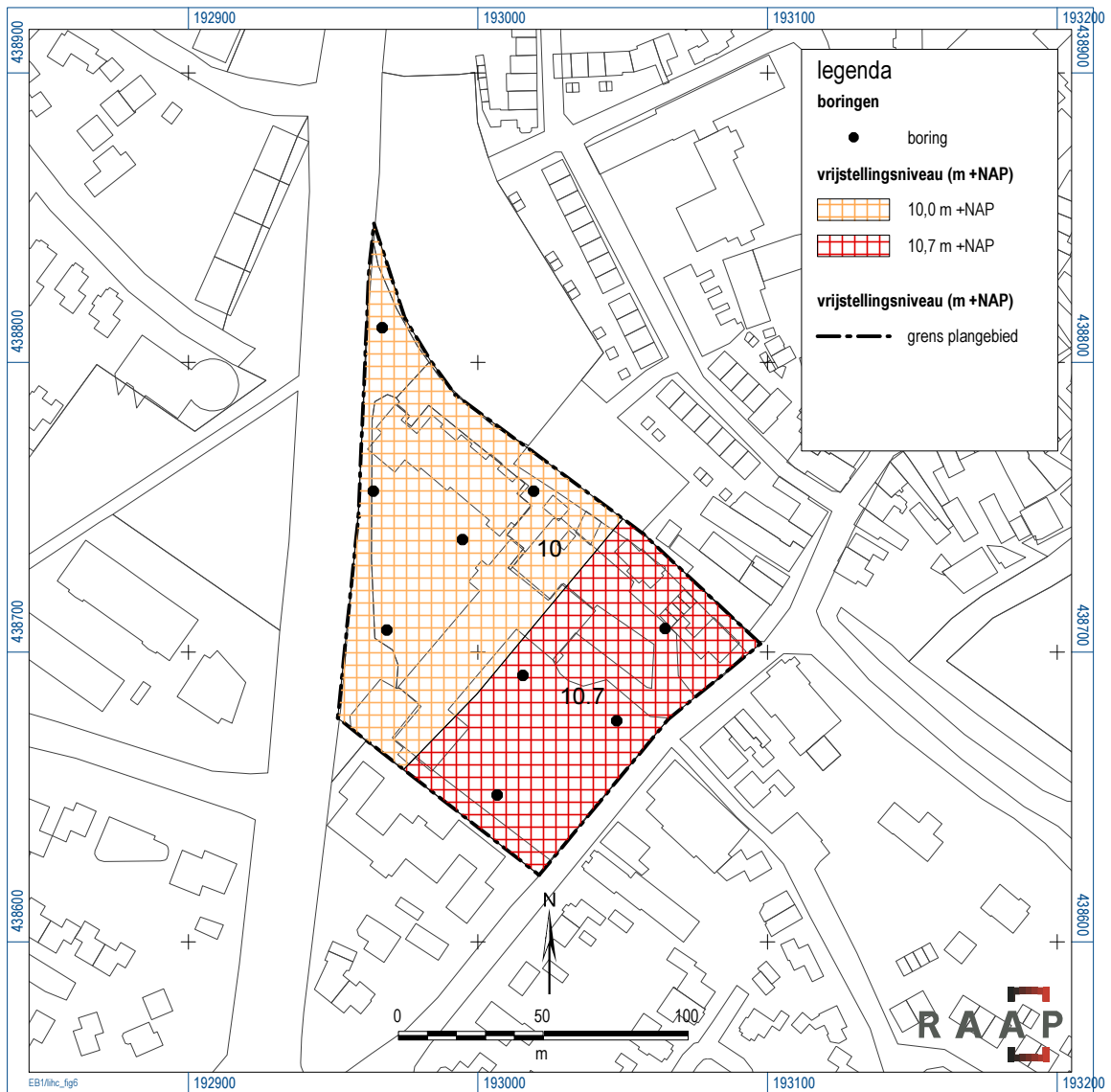
Figuur 10. Advieskaart met NAP-niveaus waarboven geen archeologisch onderzoek noodzakelijk is. Bij bodemingrepen op een lager dan het genoemde NAP-niveau dient archeologisch onderzoek plaats te vinden.
