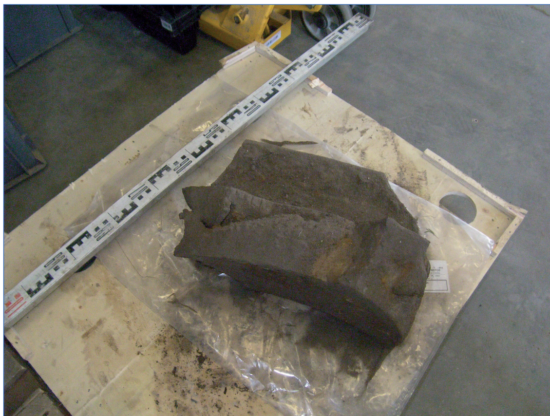
Figuur 13. Fragment van de deur van gietstalen koepel van de kazemat.
