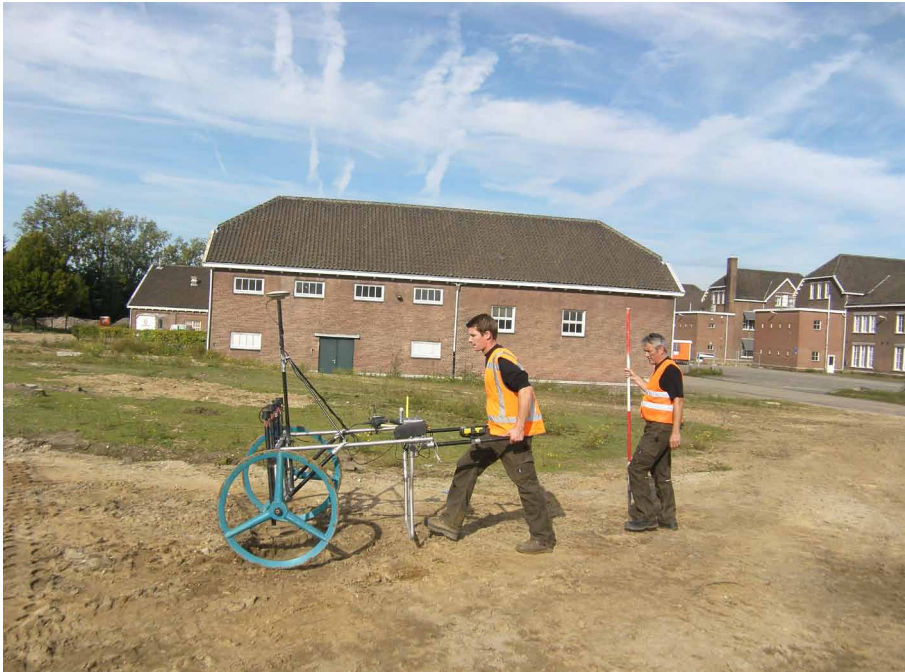
Afb. 6.1 Inmeten mogelijke explosieven met behulp van een multisensor.
