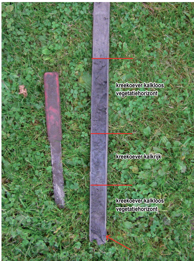
Figuur 12. Kreekoeverafzettingen met dubbele laklaag en Romeins aardewerk (bij rode pijl) in boring 97 (zie bijlage 1 voor boorbeschrijving).
