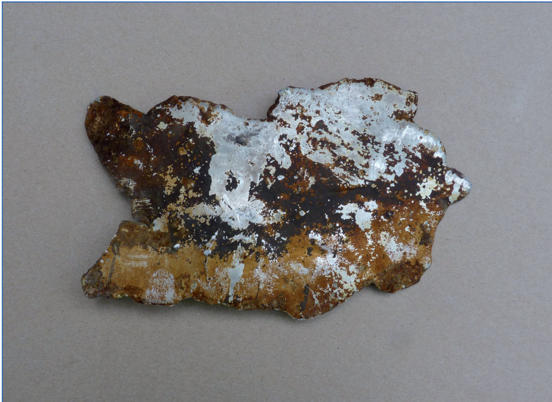
Figuur 9a. Versplinterde aluminium resten die bij de twee kraters zijn aangetroffen (zie figuur 9b voor de maatbalk).
