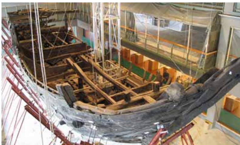
380 Een kijkje in de Bremer kogge. Te zien is dat in de binnenconstructie allerlei lange rechte balken zijn toegepast. Wellicht is balk D een dergelijke balk.
