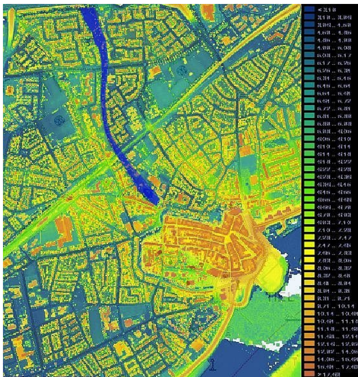
Afbeelding 2.2. Het voormalig stroomgebied van de Linge op de AHN (in blauw) ten noorden van het centrum ( www.ahn.nl ).
