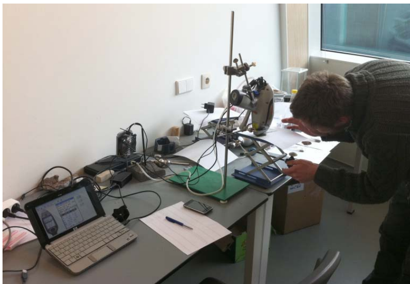
Figuur 67. Meetopstelling van de XRF met direct op de laptop afleesbare meetwaarden, foto toont het positioneren van het monster tegen het meetvlak (uit: Arnoldussen 2012, 55 fig. 39).
