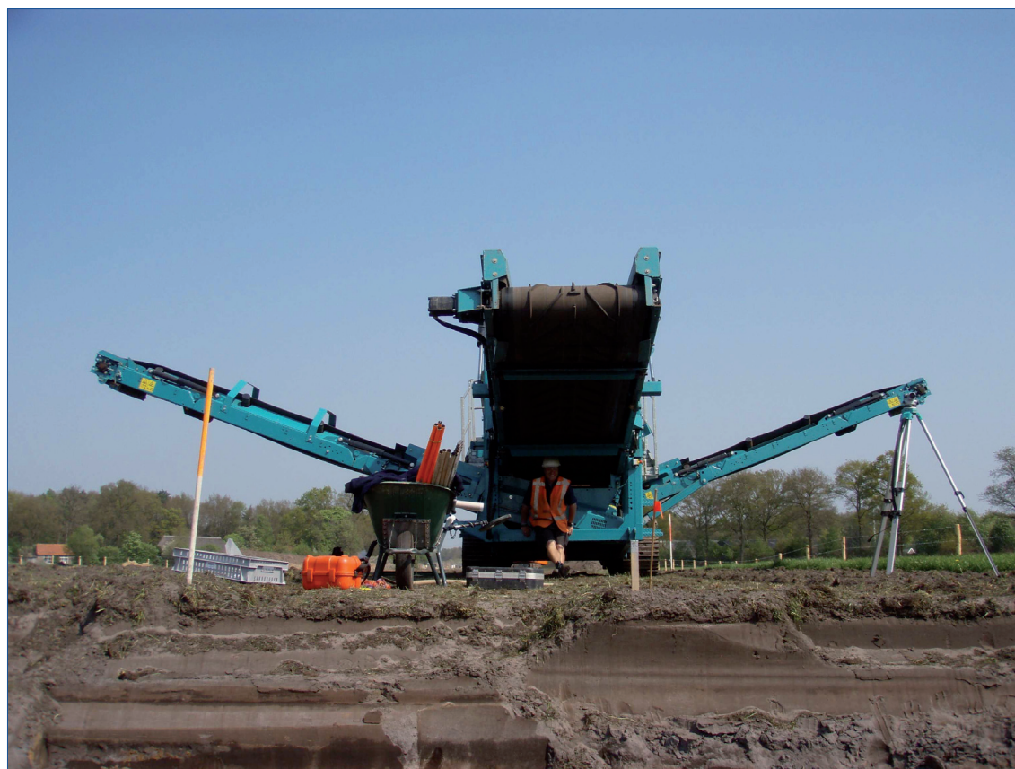
Figuur 4. Om vondstmateriaal uit het esdek te verzamelen, is gebruik gemaakt van een zeefmachine van het type Warrior 1400.
