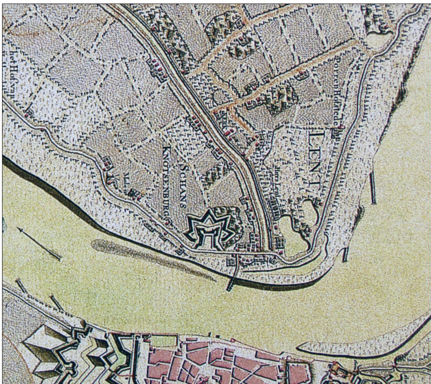
Figuur 8.3. Fragment Hottingeratlas (1773–1794) waarop globaal de meeste noordelijke ligging van de Waalgeul is weergegeven. Met kribben en langsdammen werd de geul weer van de dijk afgedirigeerd. Op de kaart zijn enkele grote wielen weergegeven die zijn ontstaan in de 16 e eeuw.
