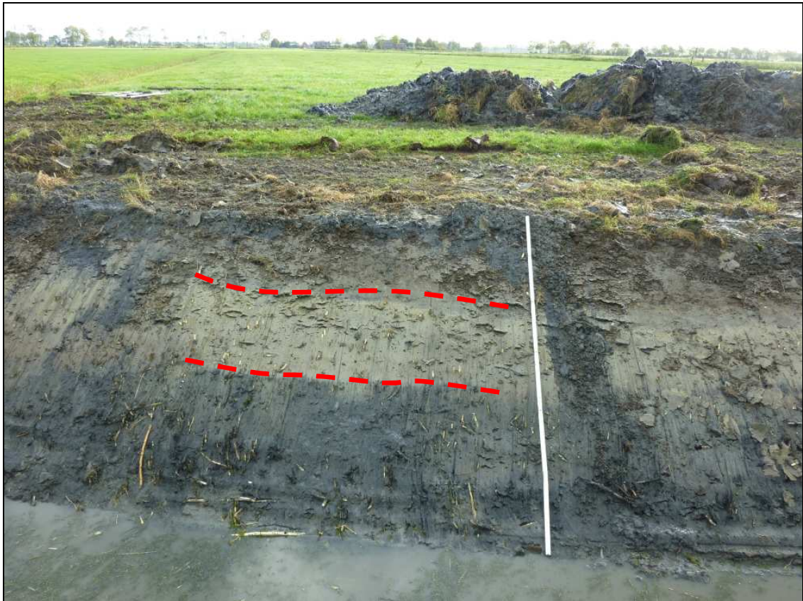
Afbeelding 5. Opname van het oostprofiel (op circa 100 m vanaf de weg aan de noordkant van het plangebied) waarbij de bodemopbouw goed te herkennen is. De bodem bestaat van boven naar beneden uit de bouwvoor en een pakket jonge zeeklei gescheiden wordt door vegetatieniveaus (rode stippellijn).
