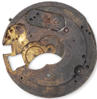
Afbeelding 104. Achterplaat van een horloge met uitsparingen voor het raderwerk (V145) uit de stort. Datering 19e-20e eeuw. Schaal 1:1.
