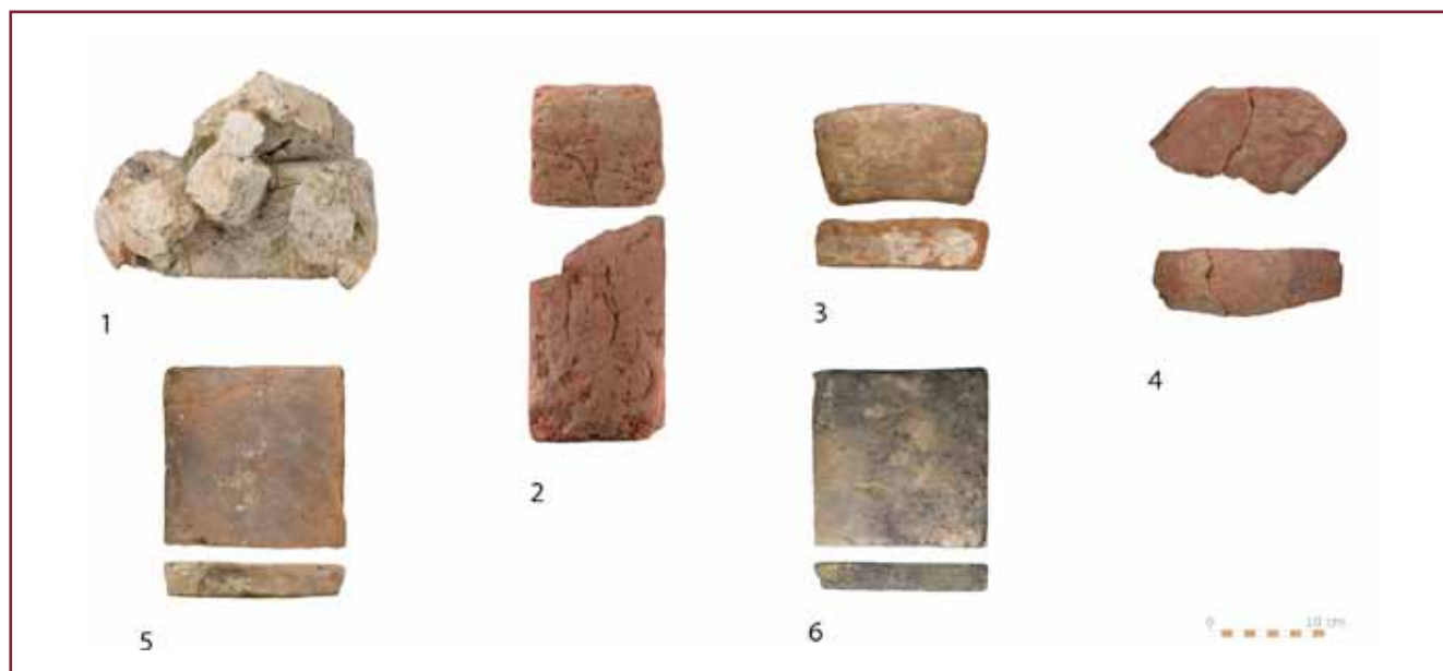
Afbeelding 9. Bakstenen en plavuizen uit diverse sporen. Nr. 1 misbaksel van bakstenen; nr. 2 zogenaamde bloemsteen; nr. 3 gebogen baksteen; nr. 4 geprofileerde baksteen, raamtracering?; nr. 5 en 6 plavuis.
