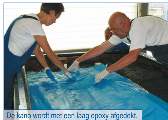
Vorbereiding voor de epoxymal.
