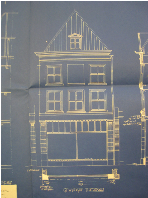
Afbeelding 29 De voorgevel in de nieuwe toestand, zoals voorgesteld in het plan van 3 september 1921.
