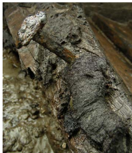
Figuur 4.26 Streng wol tussen kielbalk en zandstrook (foto: D.Postma, Nieuw Land).
