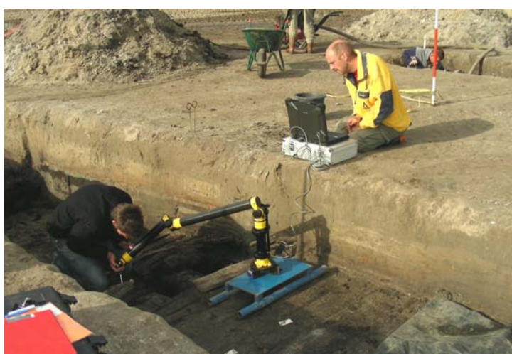
Figuur 3.7 CimCore meetarm in gebruik (foto: A. Overmeer, Nieuw Land).
