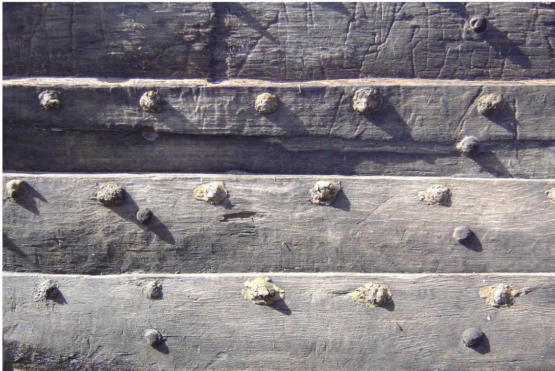
Figuur 4.16 Scheepshuid met klinknagels en houten pennen (foto: R. Reinders, GIA).
