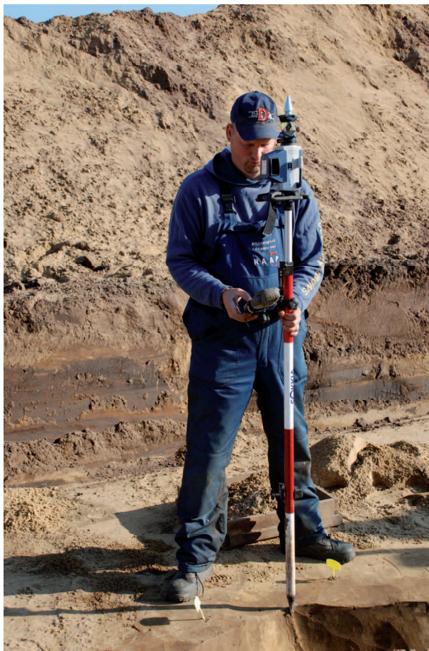
Figuur 4. Het inmeten van grondsporen met een Robotic Total Station (RTS).
